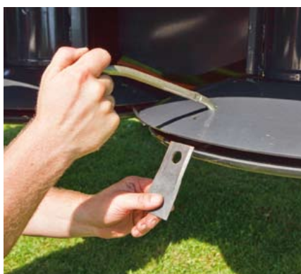
Messen worden gemakkelijk gewisseld met een speciale hendel. Eenvoudig naar beneden drukken en de messen zijn ontgrendeld.
