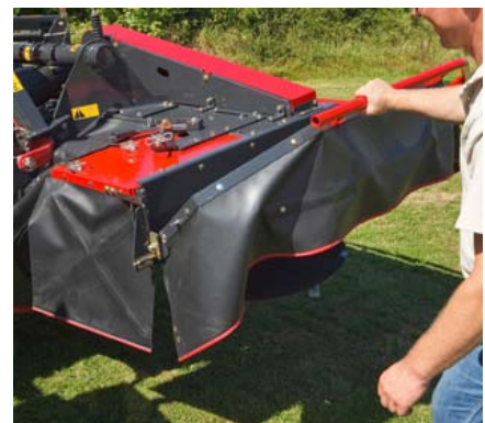
Buitenste beschermkappen worden eenvoudig opgeklapt voor smal transport.
