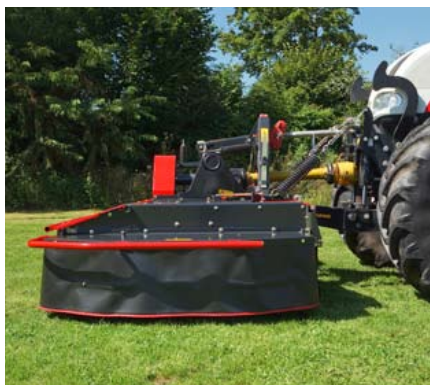
Instelling van de maaihogte door middel van afstandsringen.
