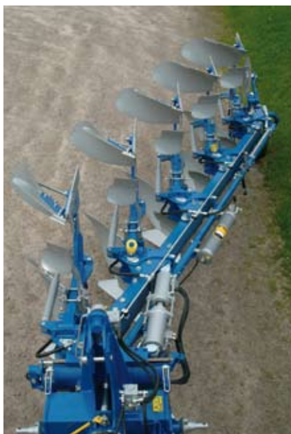
De optimale geometrie van de ploeg resulteert in minder krachten tijdens het verstellen van de werkbreedte en het wentelen.
