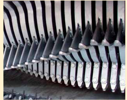
De rotor van 175 cm heeft een schroefvorm voor een constante vermogensopname.
