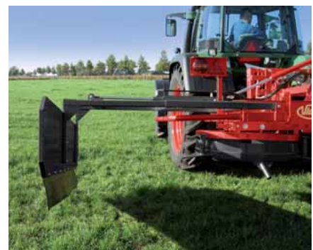
Traploos hydraulische werkbreedte van de Duplex 600 tot wel 6 m.
