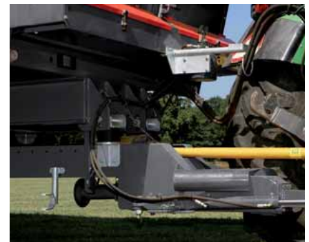
Geveerde trekboom door middel van rubberen blokken.
