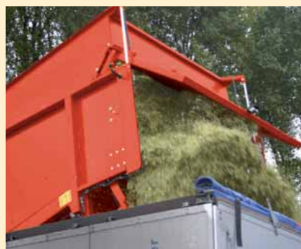
Tijdens het openklappen van de achterklap schuiven de zijwanden en achterwand omhoog.
