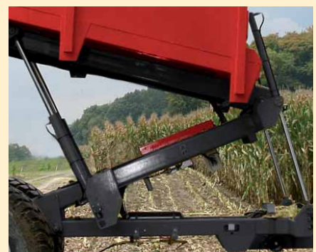
Via een schaarconstructie wordt de wagen hydraulisch opgeheven.
