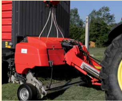
De pick-up met een breedte van 185cm heeft een in hoogte verstelbare kortgewasplaat met rol en vaste veertanden voor een optimale gewasstroom naar de rotor.
