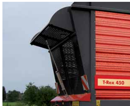
Een schuinlopend voorschot met scharnierend bovendeel.
