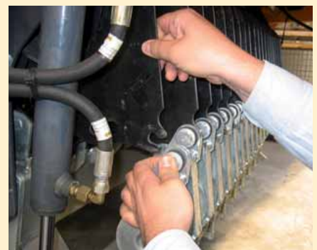
Door de snelsluiting kunnen de messen snel en veilig worden gewisseld.
