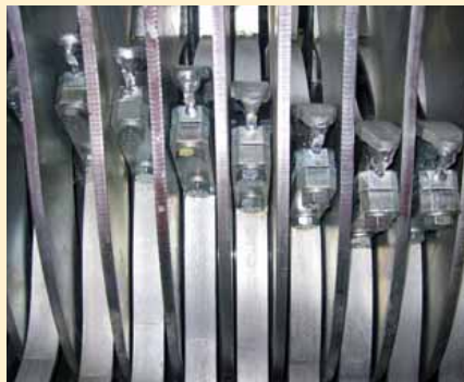
Dankzij schroefverbindingen kunnen de invoerfingers bij beschadiging eenvoudig worden verwisseld.
