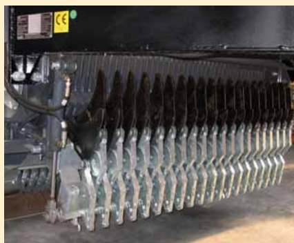
De snijlengte kan op 38 of 76 mm worden ingesteld door middel van twee groepen messen.
