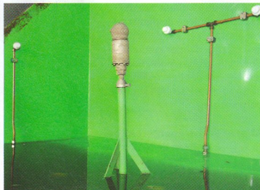
De kist wordt ondersteboven op de reinigingskop geplaatst. De andere sproeiers zijn voor naspoelen.
