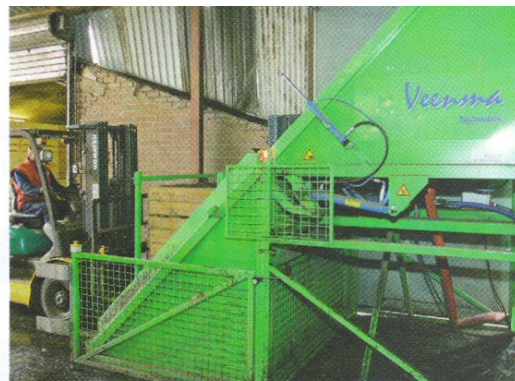
Nadat een kist in de klep is geplaatst, klapt deze op. Klep en wasser vormen ingeklapt een kubus.
